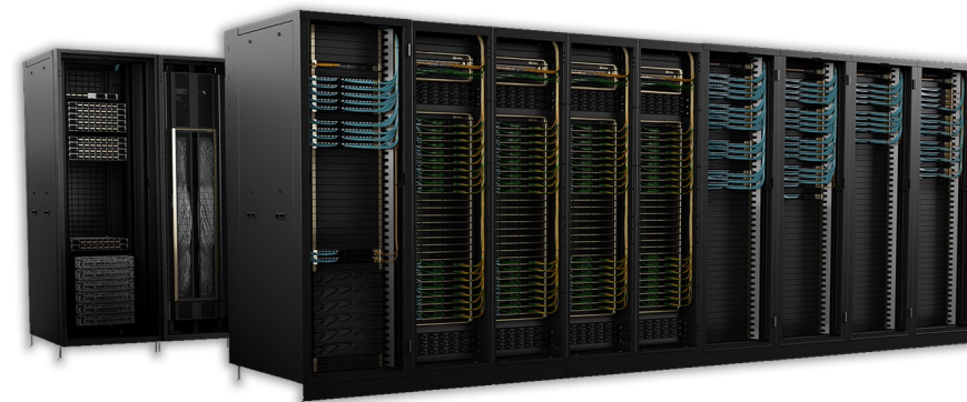
NVIDIA DGX SuperPOD mit DGX GB200 Systemen ( besteht aus 8x DGX GB200 NVL72 inkl. NVLink )
