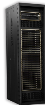
DGX GB200 NVL72 [ besteht aus 18x GB200 Compute Trays (72x GPUs) inkl. NVLink ]
